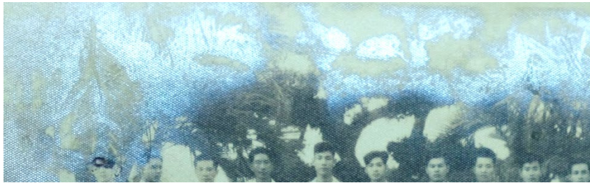
圖 3-26 明膠銀鹽相片銀離子析出之劣化狀況 (本研究者拍攝)
