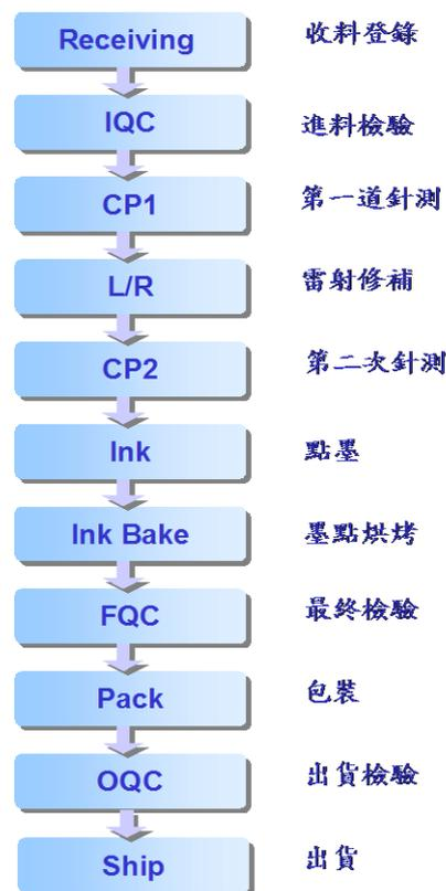
圖 4 晶圓測試流程圖
