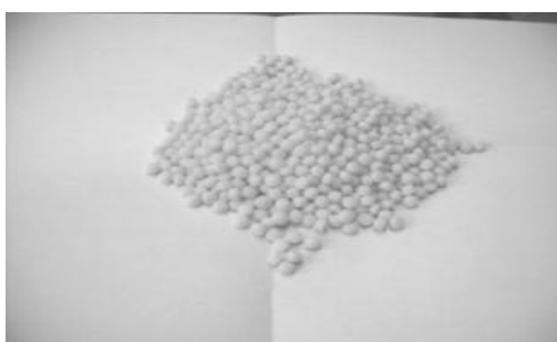
圖 2a ADCA 高倍率粒狀發泡劑
