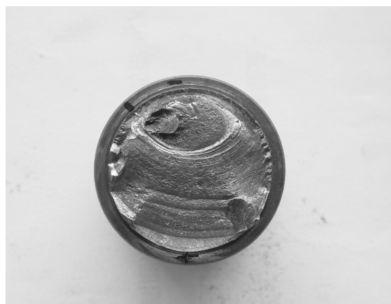
照片 3 傳動主軸之破壞面
