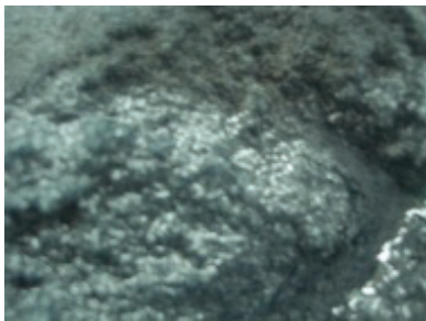
(c) 不鏽鋼奈米磨粒(200µm+樹脂)
