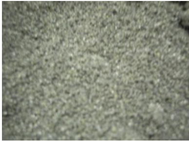
(b) 不鏽鋼奈米磨粒(200µm),
