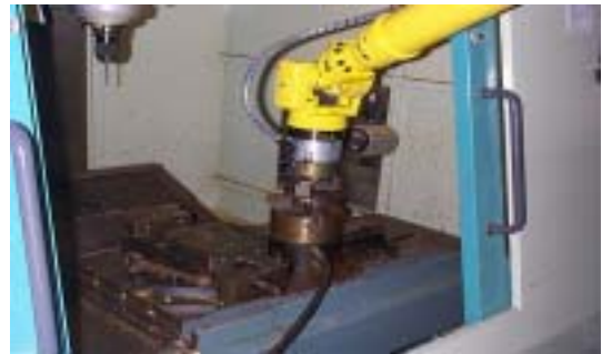
圖 19. 機械手臂夾取工件到 FV600 切削加工機
