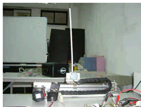
圖 16. 倒單擺實驗模組實體圖
