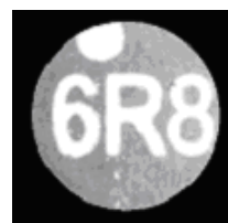
圖 9. 被切割出之電感器鐵心
