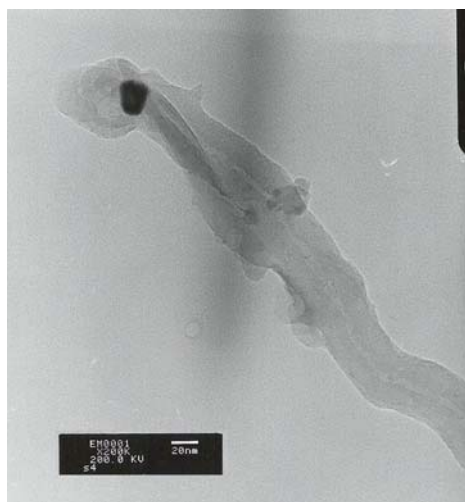
圖 7. 頂部成長模式 TEM 圖 (成長條件同圖 6)
