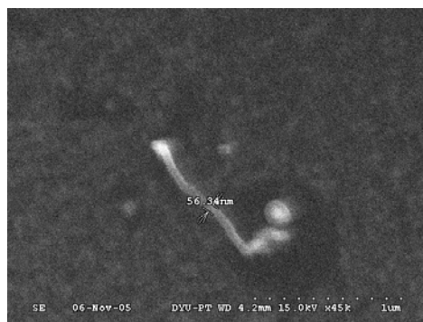
圖 3. 奈米碳管 SEM (前處理溫度 800°C)
