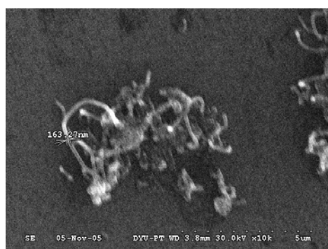
圖 4. 奈米碳管 SEM (前處理溫度 900°C)
