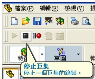
圖 10. SolidWorks 之停止巨集
