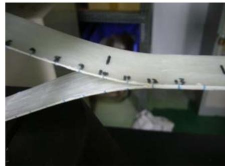
圖 17. 裂縫延展到 120 mm 處示意圖
