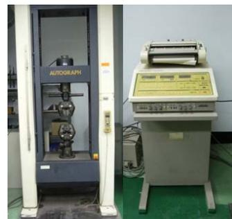
圖 11. 拉伸實驗機與操作平台
