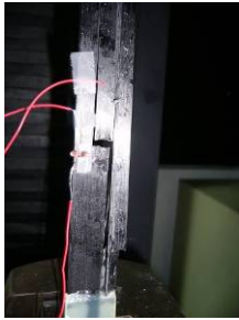
圖 64. 碳纖預浸材破壞情況
