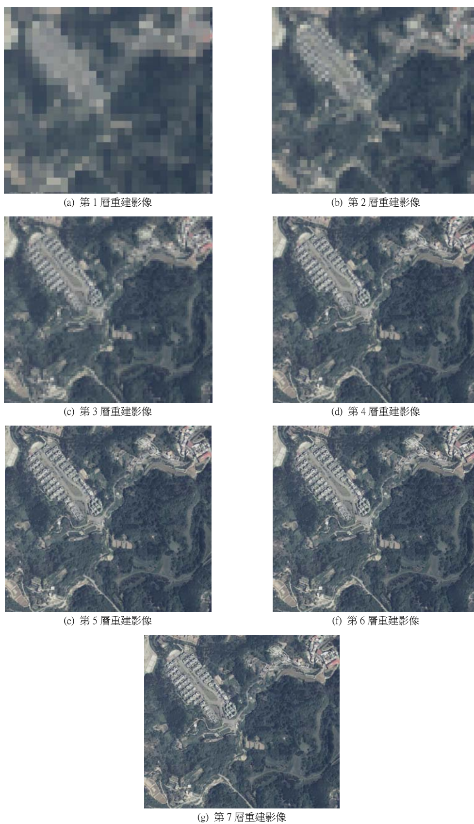
圖 8. 航照影像，小波轉換 7 層重建影像
