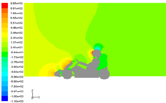
圖 10. 舊模型中心切面之壓力分布 (單位: Pa)
