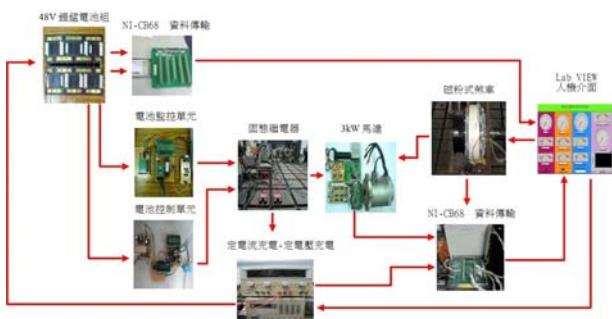
圖 8. 鋰電池診斷管理動態測試架構圖
