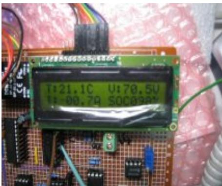
圖 15. 電池殘電量顯示器測試顯示圖
