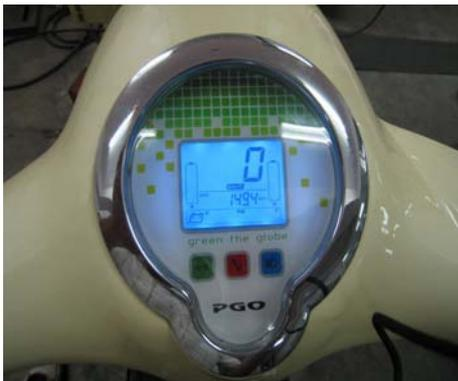
圖 19. 電動機車殘電量顯示錶頭
