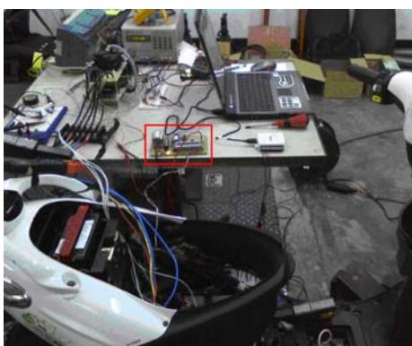
圖 18. 電池殘電量顯示模組實測（二）
