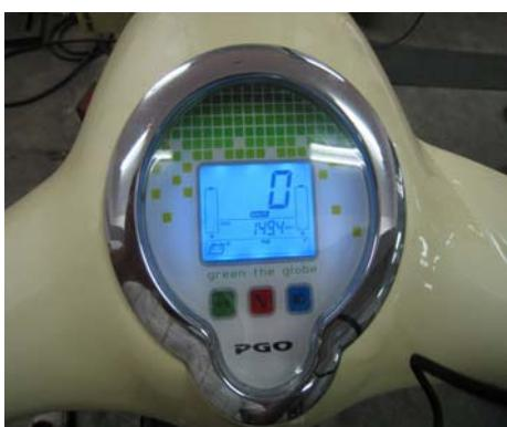
圖 19. 電動機車殘電量顯示錶頭
