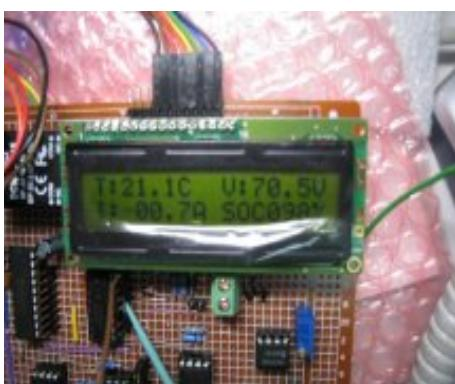
圖 15. 電池殘電量顯示器測試顯示圖
