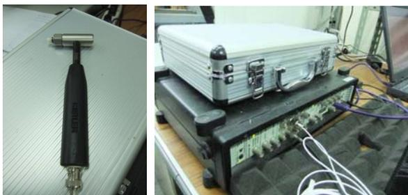
圖 13. 敲擊鎚（AU02）與訊號分析儀
