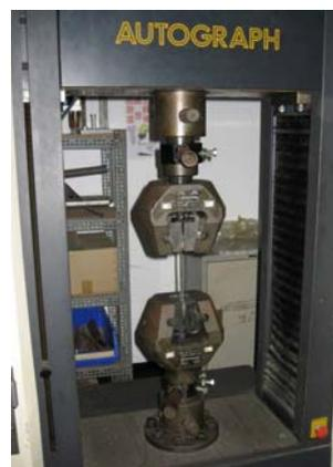
圖 9. 萬能拉伸材料試驗機 (SHIMADZU AG-25TE)
