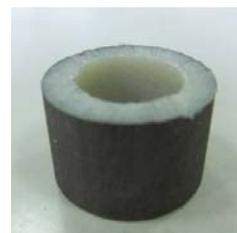
圖 12. 耐磨耗標準試片
