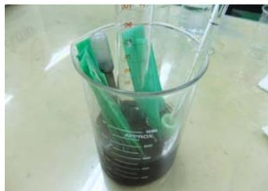
圖 6. 試片浸泡錫鈮膠體觸媒溶液
