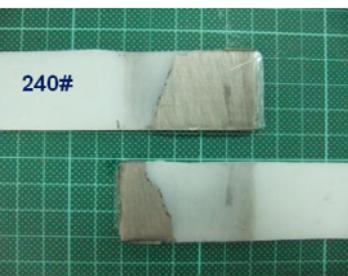
圖 27. PE (240Cw) 剝離情況
