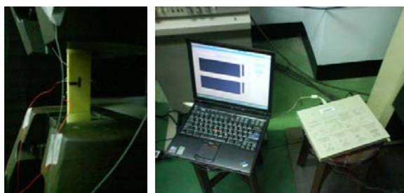
圖 15. 將試片上之應變規連接取值系統
