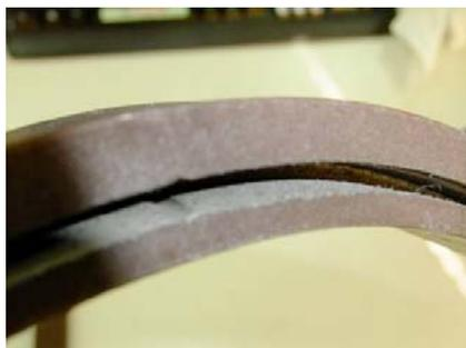
圖 47. 無電鍍於彎道凹槽
