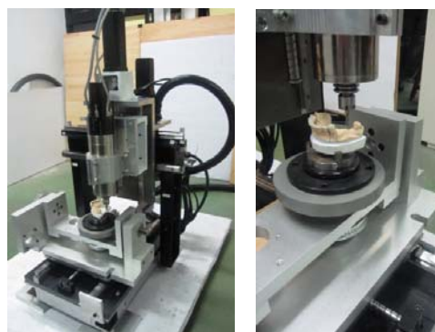
圖 10. 石膏牙模固定於五軸機台示意圖
