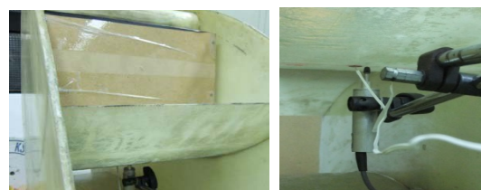
圖10. 電子位移計架設圖
