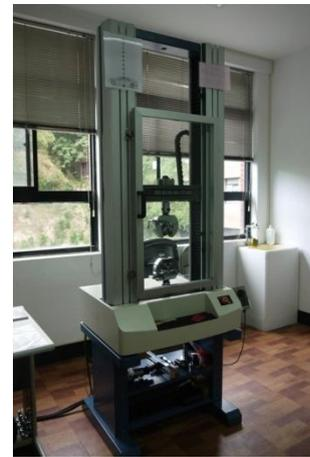
圖4. HT-2402 材料試驗機
