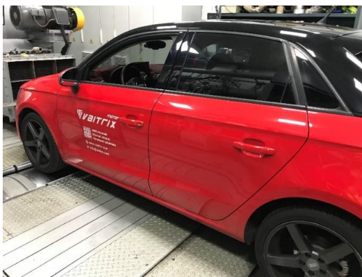
圖 7. 動力計與實驗車之安置
