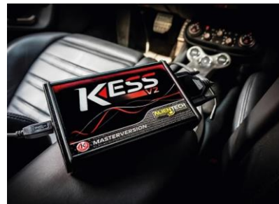
圖 3. OBD 寫入 ECU 控制程式
