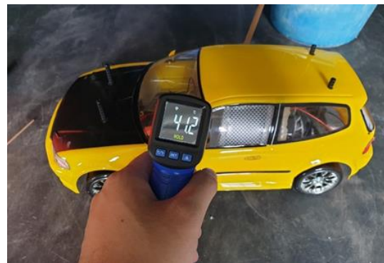
圖 16. 利用紅外線測溫器量測車室溫度
