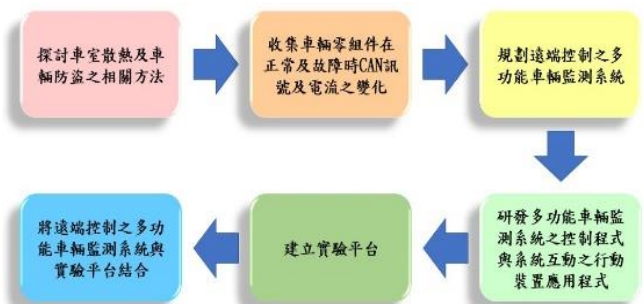
圖 12. 遠端控制之多功能車輛監控系統之研究架構圖
