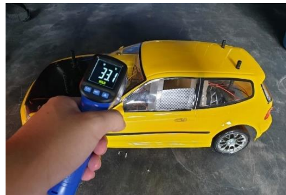
圖 17. 系統作動 3 分鐘後量測車室溫度
