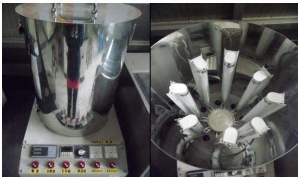
圖 2. 染料降解之實驗裝置
