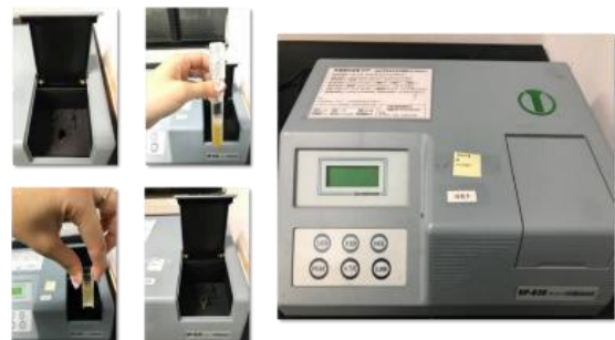
圖 9. 測量菌液之 OD 值與分光光度計
