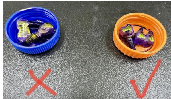
圖 24. (左) 沒鍍膜的牙根浸泡 CV 溶液 15 分鐘 (右) 有鍍膜牙根浸泡 CV 溶液 15 分鐘
