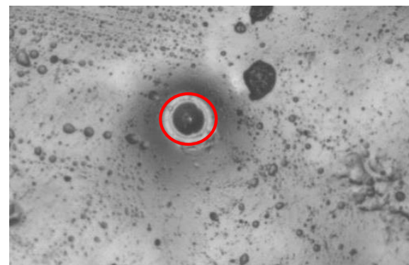
圖 17. 塗佈 \text{Al}_2\text{O}_3 -2% 奈米醫用樹脂試片的 OM 觀察
