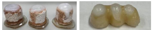
圖 5. (左) 在陶瓷試片孔洞中添加奈米醫用樹脂示意圖 (右) 陶瓷假牙裂縫中添加奈米醫用樹脂示意圖
