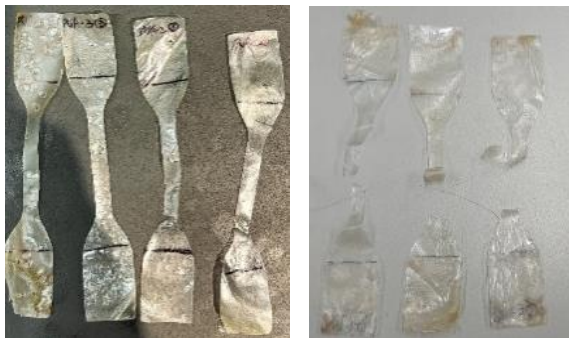
圖11. 活性薄膜的拉伸試片及斷裂試片
