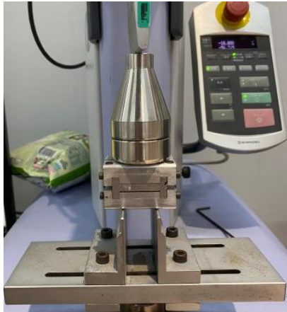
圖 19. 脊椎融合器進行頂壓測試
