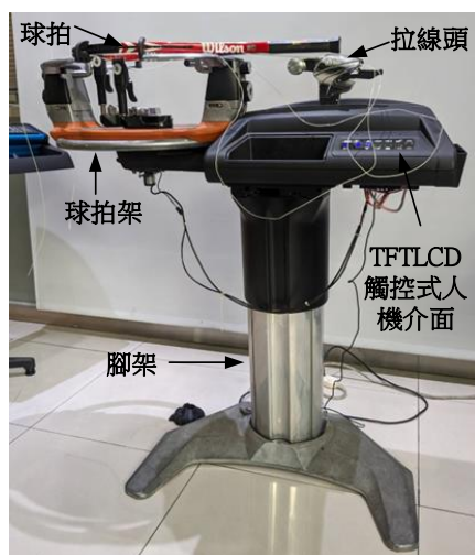
圖 20. 球拍穿線機實際硬體
