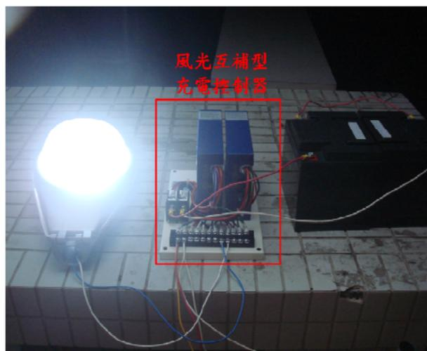
圖 18 風光互補型充電控制器
