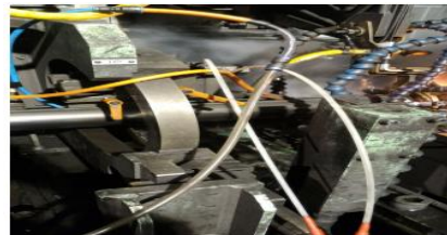
圖四 抽水管安裝完成圖
