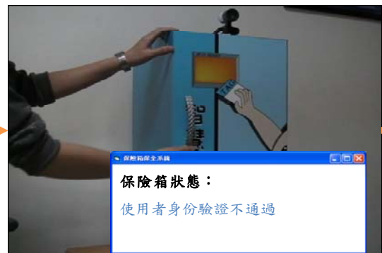
2. RFID 讀取器將讀取到的資料傳送至保全系統。接著保全系統會以此資料來搜尋資料庫，搜尋結果為不符合則代表驗證不通過
