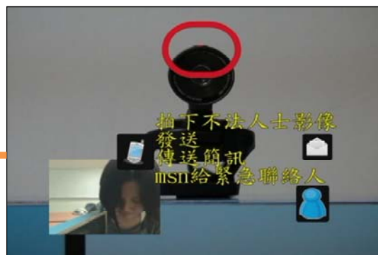
3. 保全機制保含有：拍照、錄影並且發送手機簡訊、MSN訊息、E-mail給緊急聯絡人
