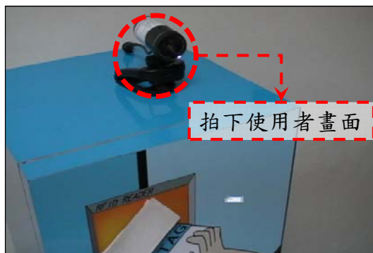
3. 使用者驗證不通過，攝影機將拍下使用者畫面的照片，再將照片夾帶至電子郵件且發送給緊急聯絡人
