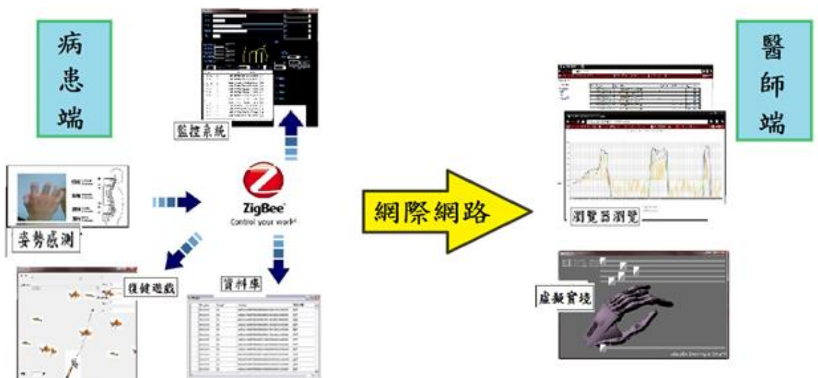
圖 17 用虛擬實境及遊戲增強遠距離手部復健診療系統架構圖
