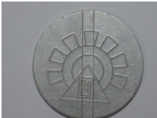
圖 14. 沖壓深度為 0.4mm 之表面狀態放大圖
