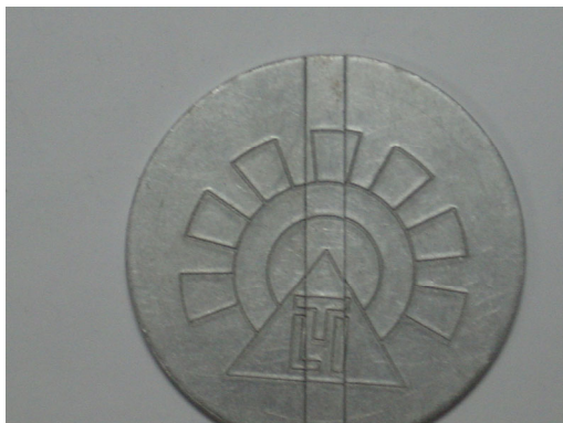
圖 15. 沖壓深度為 0.5mm 之表面狀態放大圖
