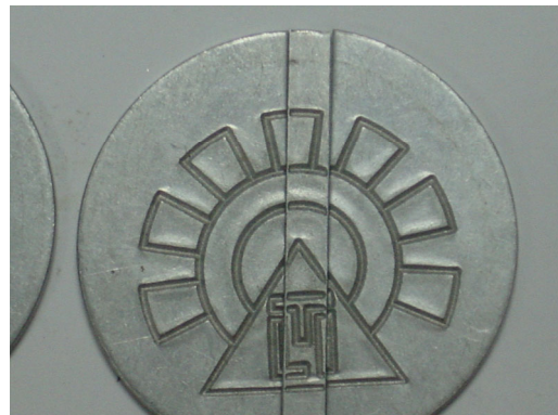
圖 17. 沖壓深度為 0.9mm 之表面狀態放大圖
