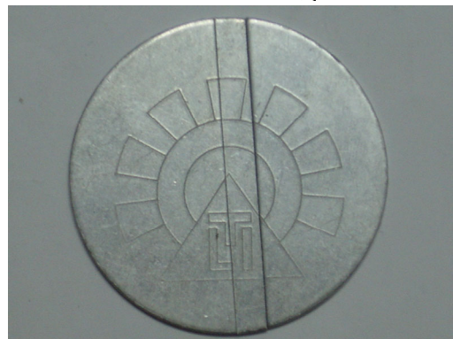
圖 11. 冲壓深度為 0.1 mm 之表面狀態放大圖
