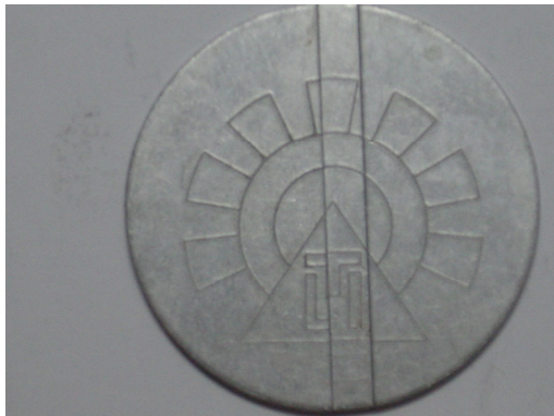
圖 12. 沖壓深度為 0.2mm 之表面狀態放大圖
