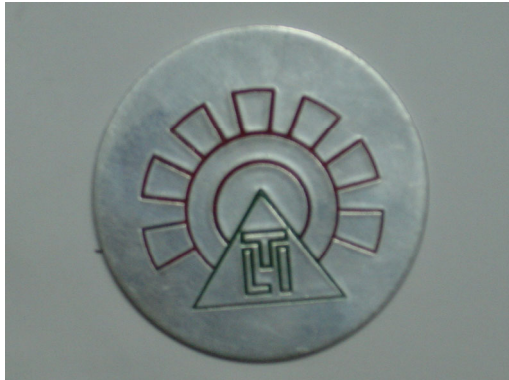
圖 19. 沖壓深度為 0.5mm 表面處理完成圖
