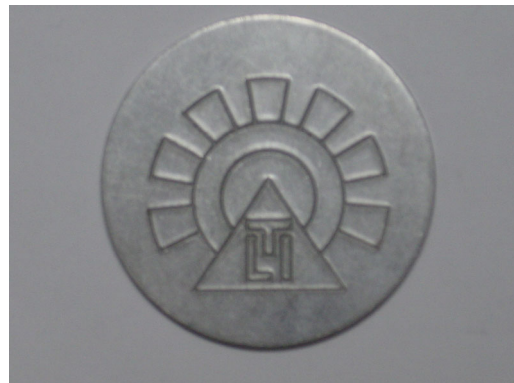
圖 18. 沖壓深度為 0.5mm 表面狀態半成品圖
