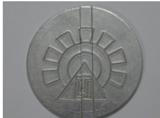
圖 16. 沖壓深度為 0.7mm 之表面狀態放大圖
