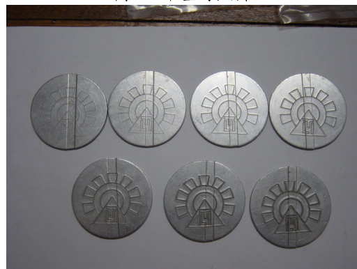
圖 10. 冲壓深度分別為 0.1 0.2 0.3 0.4 0.5 0.7 0.9mm 之表面狀態比較圖
