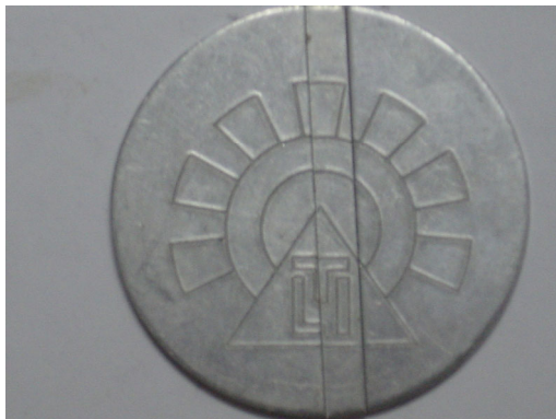
圖 13. 沖壓深度為 0.3mm 之表面狀態放大圖
