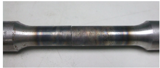
圖二 延性材料與脆性材料之拉伸曲線與實際試片對照圖。 左圖為原材，右圖為高週波加熱後淬火。
