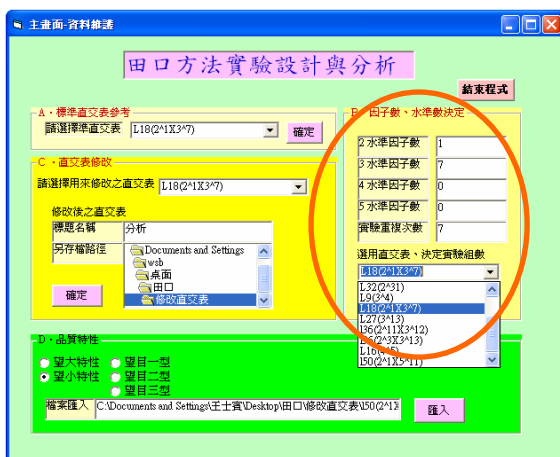
圖 5 瓷磚製程設計執行範例選項(B) 控制因子數、水準決定程式畫面
