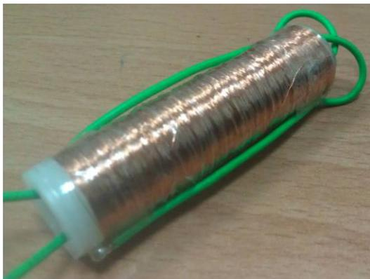
圖 6 內徑 10mm 框架無段繞線實體圖
