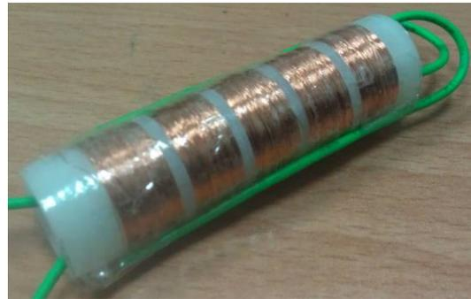
圖 7 內徑 12mm 框架分段繞線實體圖
