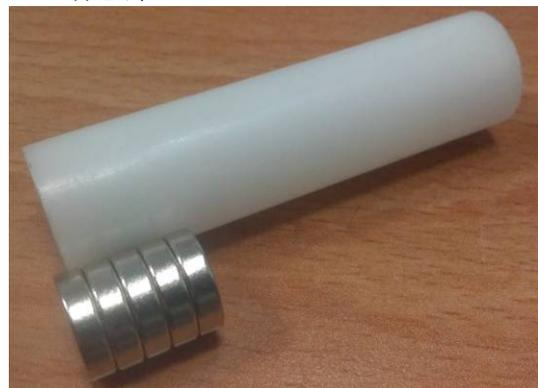
圖 4 磁鐵直徑 12mm 厚度 3mm 與線圈外框實體圖
