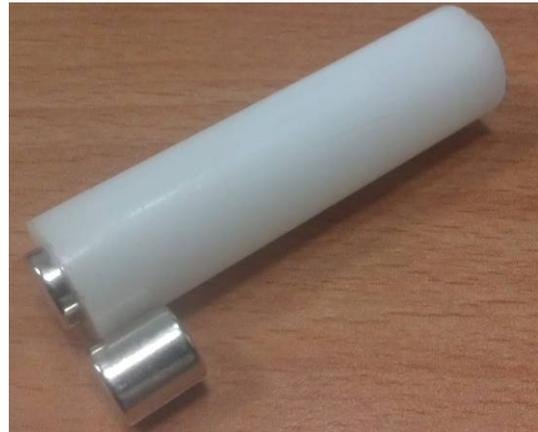
圖 3 磁鐵直徑 10mm 厚度 10mm 與線圈外框實體圖
