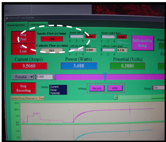
圖 11 未並聯電流可達 9.5 安培上下
