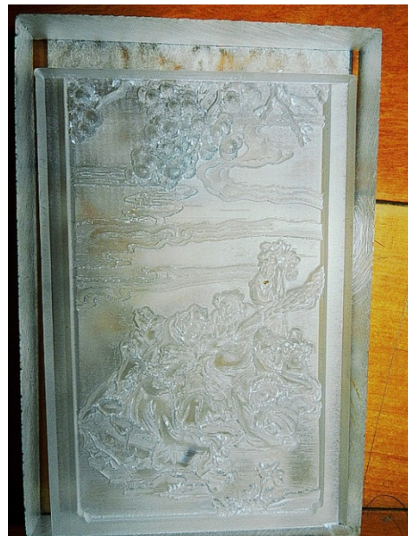
圖 13 雕刻工件成品(壓克力，三角尖刀，轉速 8000rpm，進給 20cmm)
