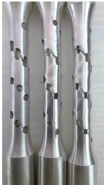
圖九 試片拉伸後之照片，顯示延性材料的斜面剪力破壞特徵，係從各孔洞之間的破斷裂紋接近45度角的現象看出。
