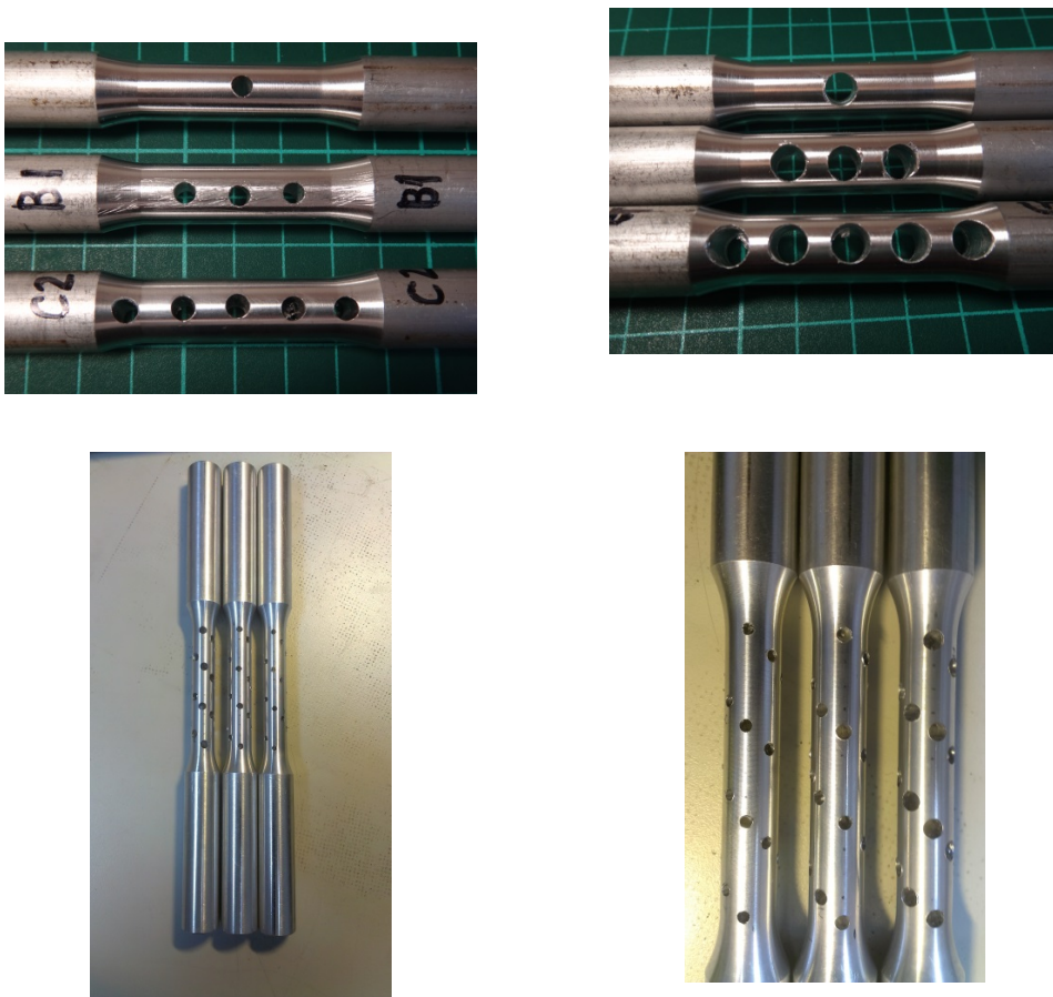
圖八 上側為具有直線排列之銷孔試片，下側為具有螺旋排列之銷孔試片
