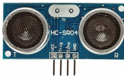
圖十八：HC-SR04超音波感測器。
