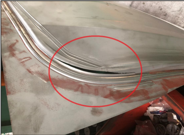
圖三十 第一次試模結果破裂處
