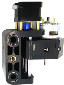
圖十四：主軸馬達與Z軸之組裝圖
