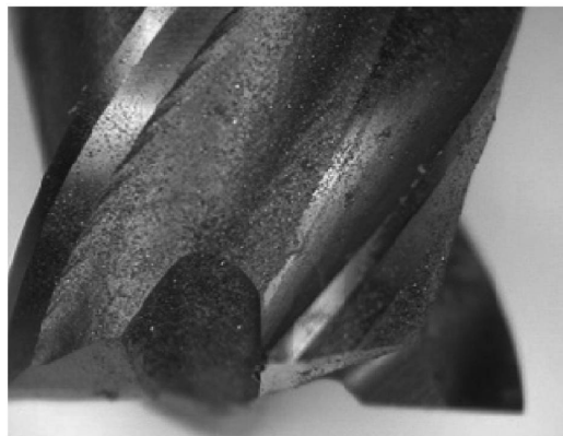
圖一:四刃平刃端銑刀側視圖
