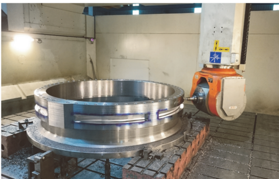
圖二十二 五軸加工機上不同刀軸朝向加工
