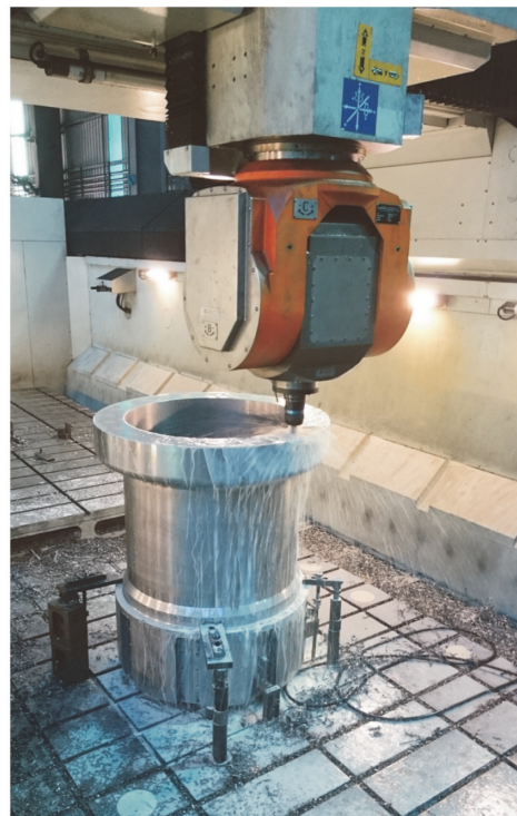
圖十九 M48x5.0 深度 110mm 盲孔飛機引擎測試架工件加工
