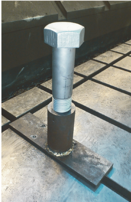
圖十六 M48x5.0 深度 110mm 盲孔內螺紋螺旋銑牙測試工件驗證
