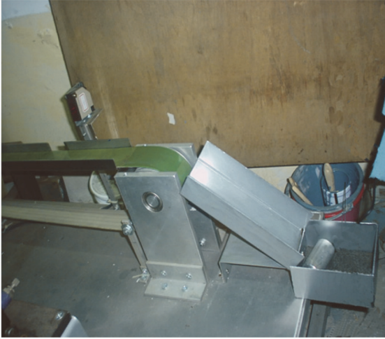
圖七 輸送帶將工件送至儲料槽
