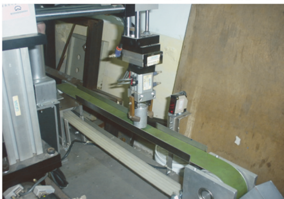
圖三 工件放置輸送帶上
