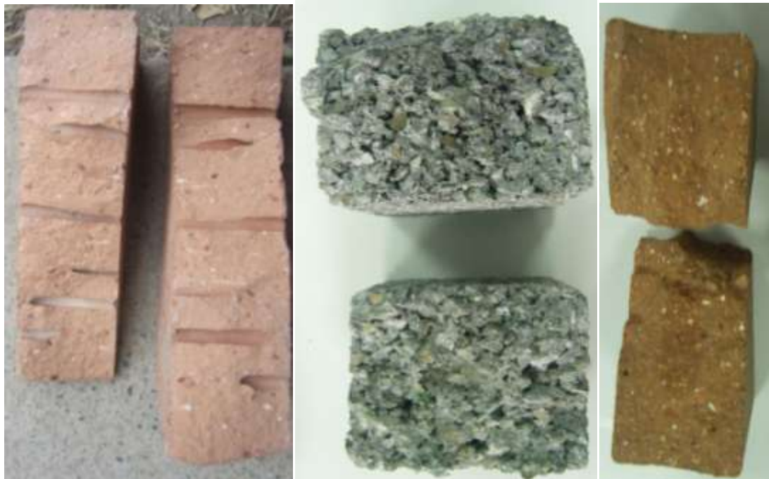
圖 11 透水磚(左)、連鎖磚(中)、紅磚(右)斷面圖
