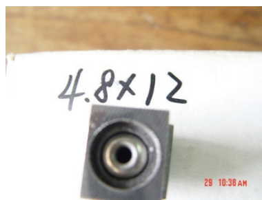
圖四 拉力試驗夾具測試拉釘結合後之抗拉強度
