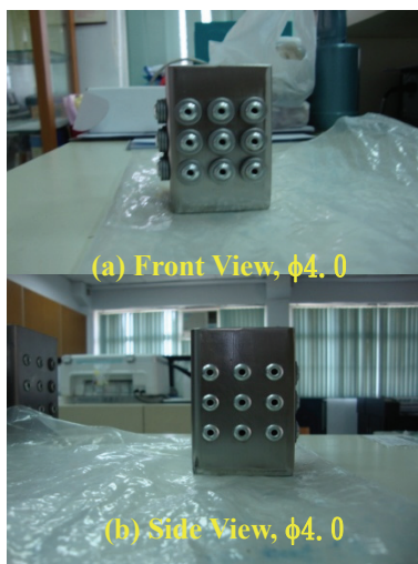
圖十八 (a) (b) SUS304 4.0mm拉釘裝置後之漏水測試
