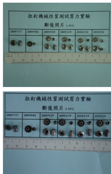
圖十四 (a) (b) 分別顯示SUS304直徑4 mm和4.8 mm拉釘隨時間日期剪力斷裂後照片
