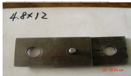
圖五 利用拉伸試驗機來測試拉釘結合後之抗剪強度
