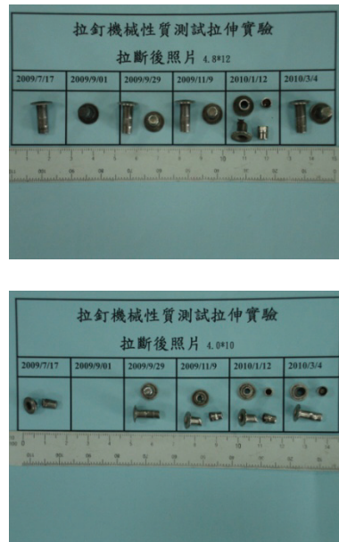
圖十一 (a) (b) SUS304直徑4 mm和4.8 mm拉釘隨時間日期拉力斷裂後照片
