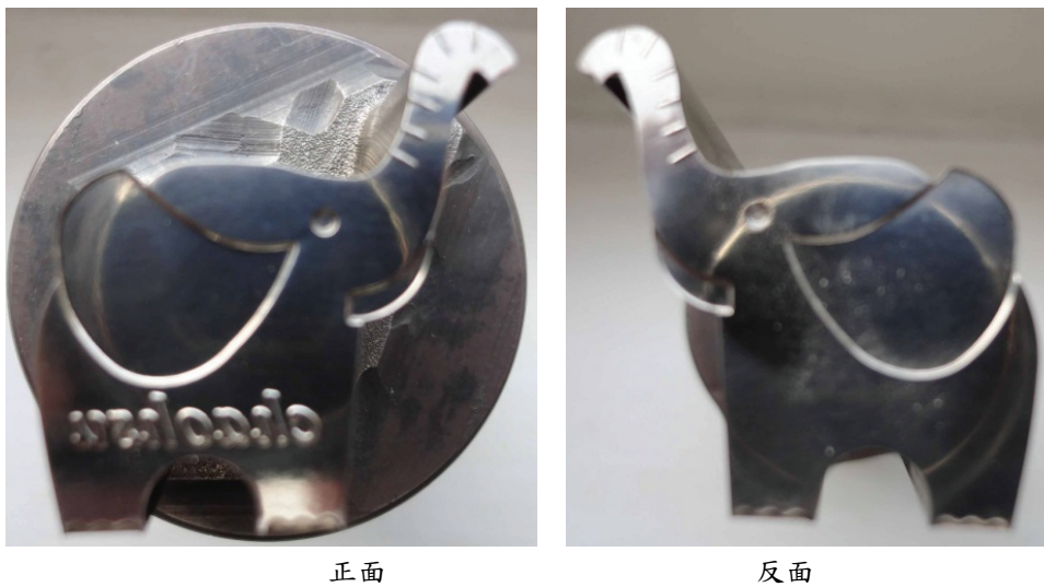
圖 3 粉末冶金模具上下沖經放電加工後之金屬吊飾品模具面取。
