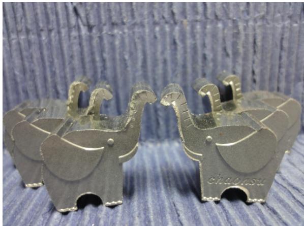
圖 6 粉末冶金製不銹鋼金屬吊飾品胚體
