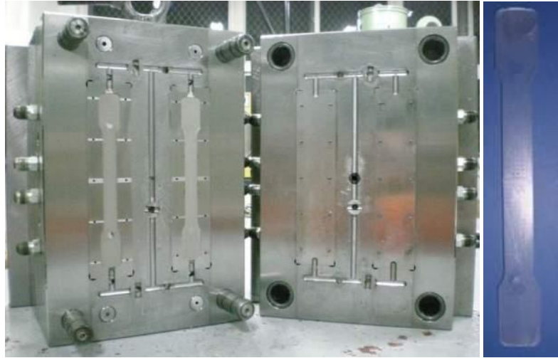
圖二 拉伸試片模具與成品
