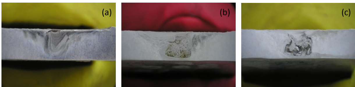
圖十五 不同轉速(a)550 rpm (b)800 rpm (c) 1100rpm (巨觀)之銲道剖面金相(5X)
