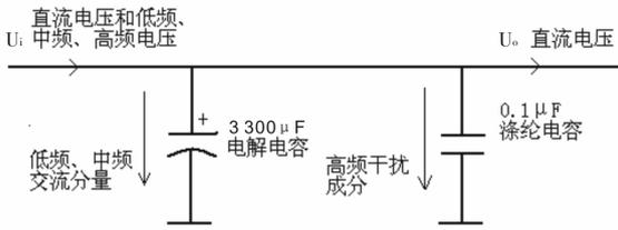
图4 电容并联滤波电路
